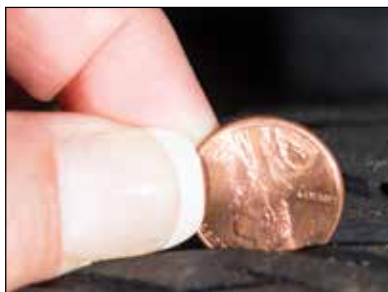
Si puede ver la parte superior de la cabeza de Lincoln, es hora de reemplazar las llantas.
